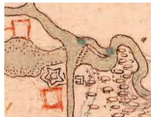
Abbildung 1.2.3: Das 1545 errichtete Zwerndorfer Wehr zwischen 1703 und 1720 (gepunktete Doppellinie in der Mitte) mit dem in Richtung Süden ausgeleiteten Mühlbach. Die sternförmige und die quadratische Struktur beiderseits des Mühlbachs sind Schanzanlagen zur Abwehr der Kuruzzen (rote Strukturen: späterer Pestwall). Nachträgliche Ergänzungen mit Bleistift zeigen Veränderungen im Gewässersystem, zum Beispiel die Ausweitung eines Flussbogens am rechten Bildrand.
