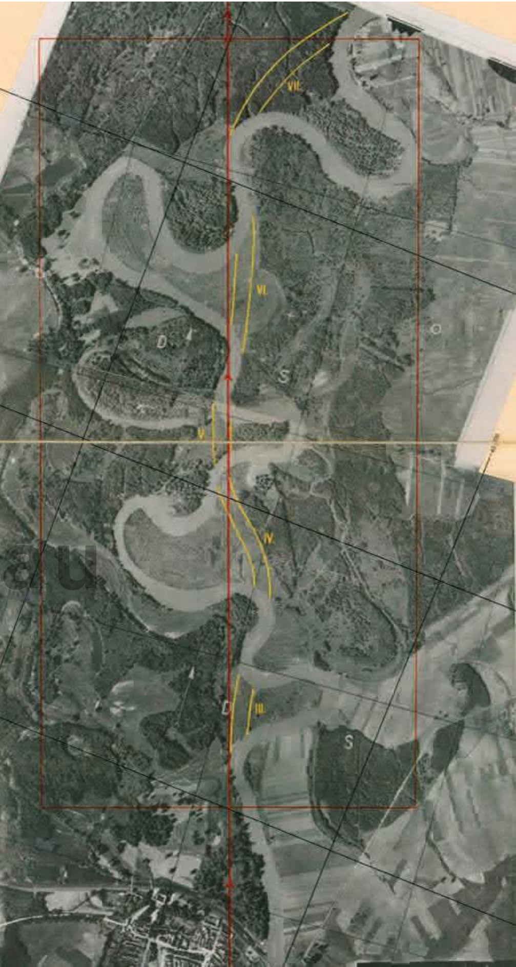
Abbildung 2.1.2: Die Durchstiche an der March flussauf von Baumgarten. Diese Luftbildaufnahme stammt aus dem Bundesamt für Eich- und Vermessungswesen, Abteilung Internationale Angelegenheit, Staatsgrenzen, die mit der kartografischen Erfassung neuer Grenzverläufe befasst ist.
