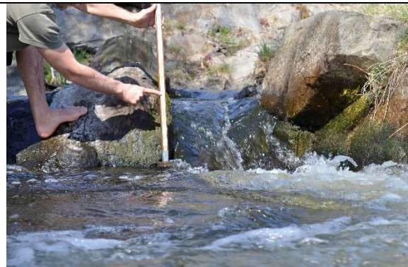
Abbildung 82: Spiegeldifferenz der Becken
